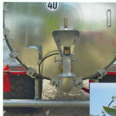
Pendelverteiler am Vakuumfass
