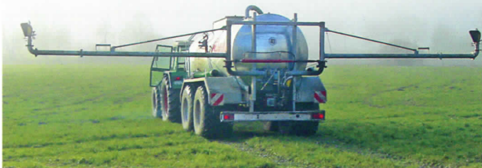
Gestängeverteiler 18-24 m Verteilbreite, wahlweise mit 2 Pendelverteiler, Prallkopfverteiler, oder Breitverteilerdüsen
