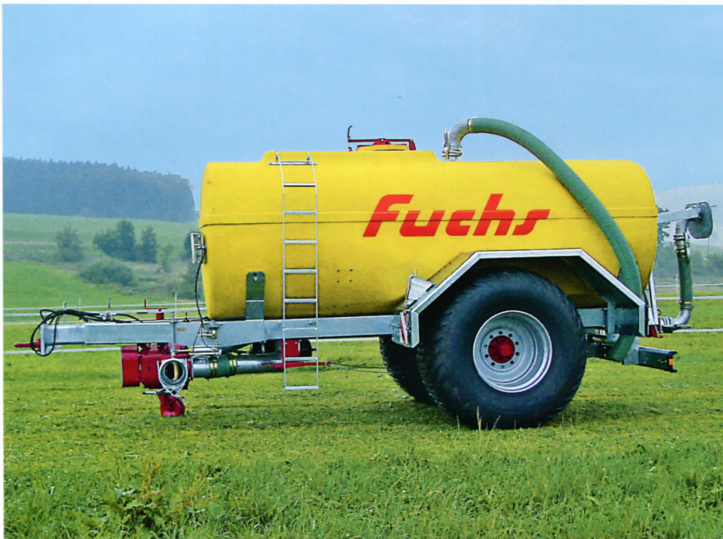
Pumptankwagen PT 10.000 l Einachs mit Einbuchtung, Bereifung 850/50-30,5, Drehkolbenpumpe, Prallkopfverteiler
