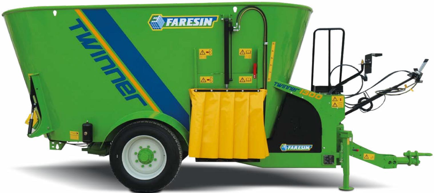
Die Twinner Baugruppe bietet 6 Modelle von 13 bis 18 m<sup>3</sup> an, alle mit 2 Schnecken mit optionalem 2-Gang-Getriebe. Die besondere Struktur ohne Gegenrahmen und die Einzelachse machen diese Modelle leicht, kompakt und extrem einfach zu bedienen.
