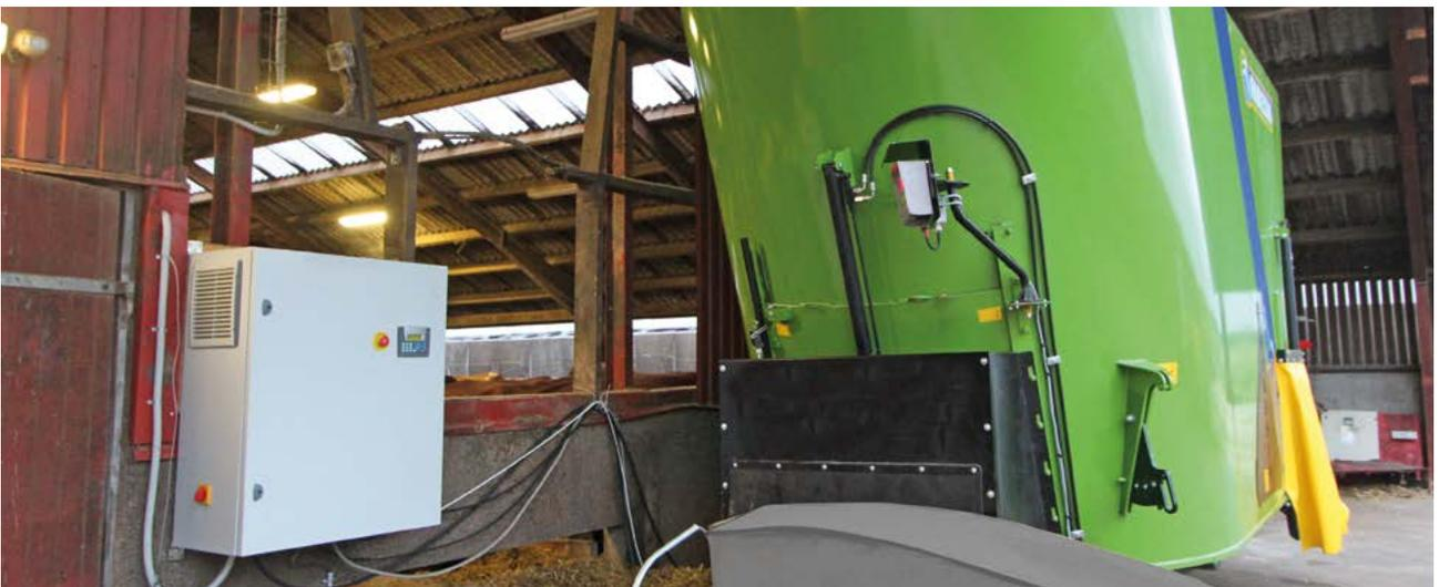
Das von Faresin entwickelte Bedienfeld ermöglicht die sichere Steuerung aller Funktionen und Befehle des stationären Mischwagens. Je nach den Bedürfnissen des Bediener und den verschiedenen Prozessen kann der Mischer mit einem mechanischen Zweiganggetriebe ausgestattet werden, das die Leistungsaufnahme begrenzt.
