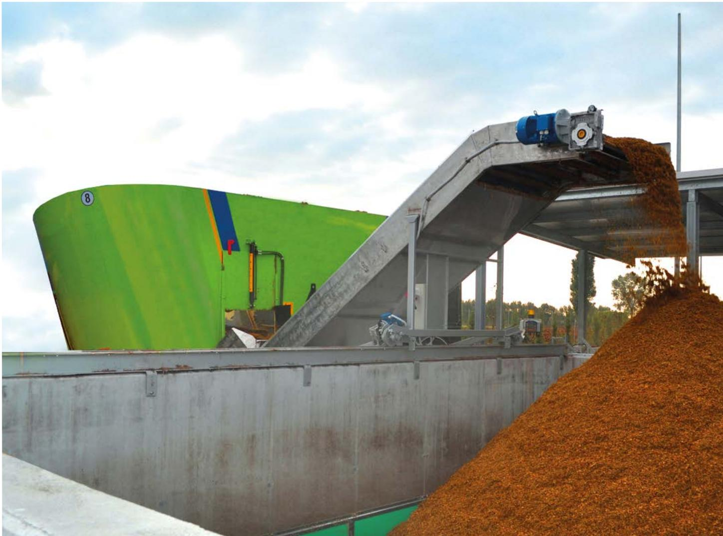
Die Stationären Futtermischwagen von Faresin sind eine geeignete Lösung für Biogasanlagen und Tierhaltungen, die Futterzyklen verwenden, bei denen die Mischung im Tank des Wagens durchgeführt und dann über andere Systeme verteilt wird.
