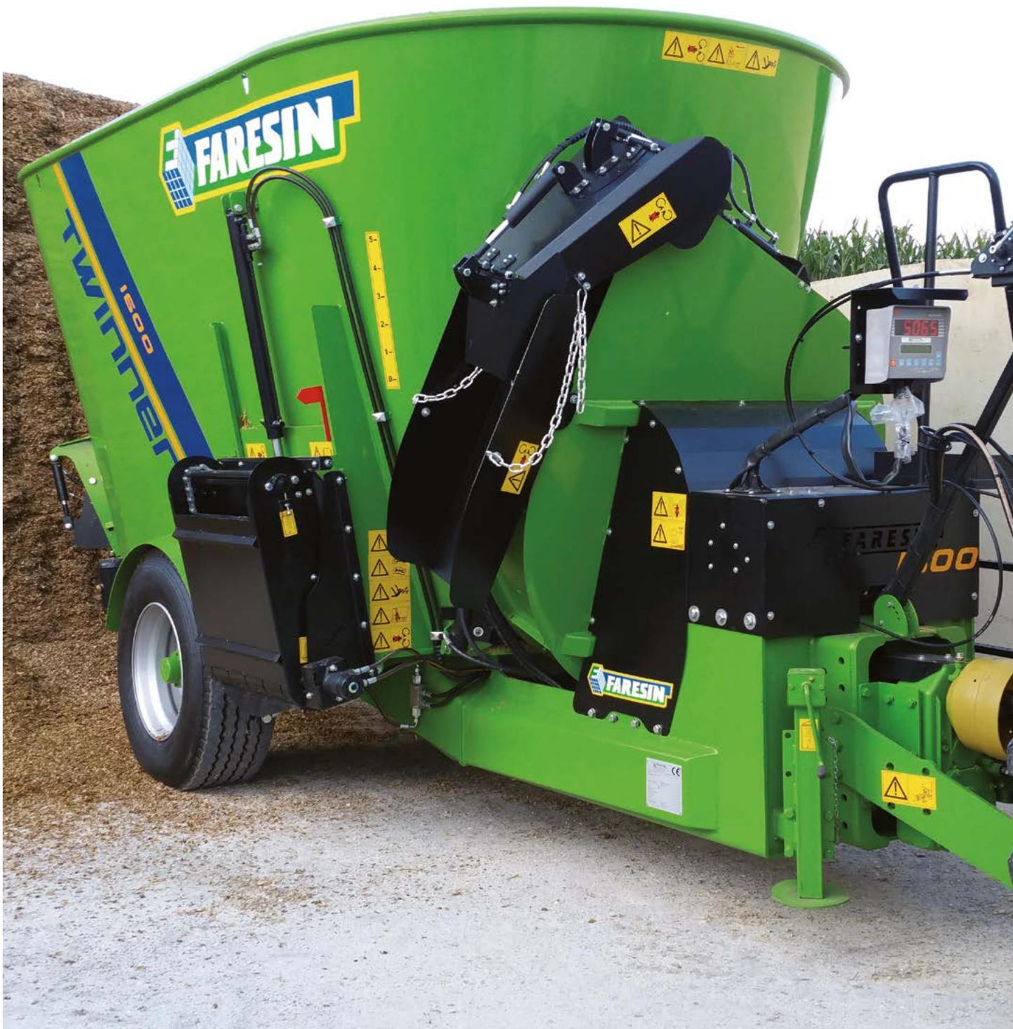
Um dem Züchter immer umfassendere und effektivere Lösungen zu bieten, führt Faresin Industries die Option des Strohgebläse mit einem Wurf bis zum 25 m im Bereich der vertikalen gezogenen Futterwagen ein, die den doppelten Zweck der Fütterung und Einstreu haben.
