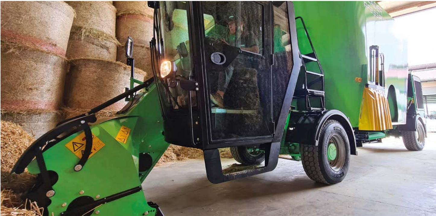
20 cm kürzerer Rahmen zur Reduzierung des Wenderadius. Die PF Leader Linie besteht aus Maschinen mit 3 Lenksysteme und 4 Antriebsrädern, die eine große Wendigkeit und Agilität ermöglichen, auch dank der Reduzierung des Lenkradius und der Rahmenneigung. Dadurch kann sich das Fahrzeug problemlos in kleinen Ställen oder mit geringem Manövrierraum bewegen.
