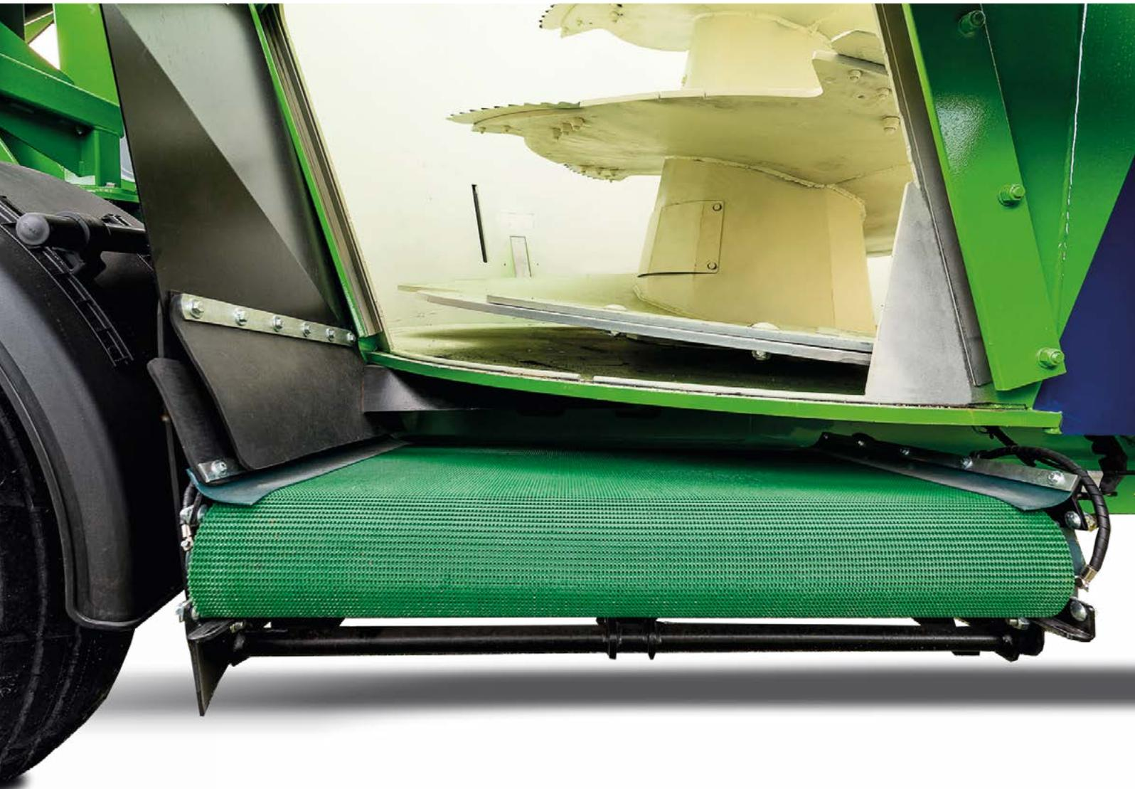
Die Kombination aus der Form der Schnecken, der Geometrie des Mischbehälters und der exklusiven Entlademesser wird eine unübertroffene Reinigung des Mischbehälters ermöglicht und eine außergewöhnliche Linearität des Auslaufs, dank der großen Größe der Klappe und der PVC-Wabenmatte.
